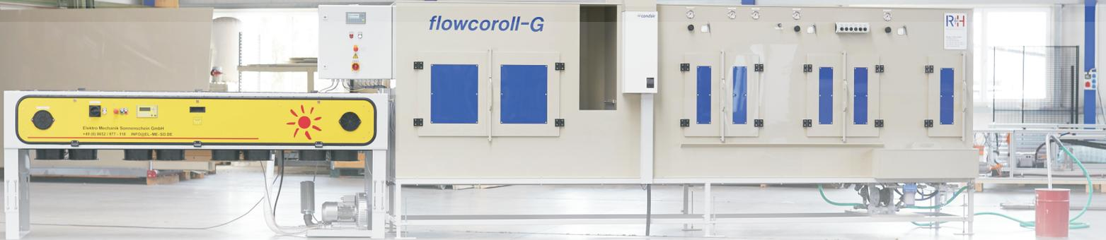
Diese Anlage wurde für die Grundierung und Zwischenbeschichtung von horizontal geförderten Einzelteilen entwickelt. Sie arbeitet nach dem bewährten Niederdruck-Flutverfahren. Die besondere Ausgestaltung des Flutkanals und des Rollentransportes ermöglicht einen schnellen Farbwechsel und eine einfache Reinigung der Anlage. Die Anlage eignet sich auch für die Verarbeitung von Materialien höherer Viskosität.
