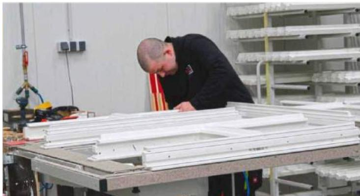
Zusammenbau der fertig lackierten Einzelteile: die Schraub-/Dübelverbindung »hält Bombe« so Christian Michels, sie ist geprüft bis RC3
