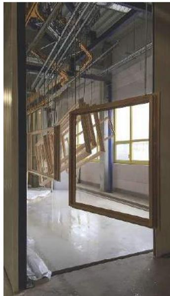
! Die neue Fördertechnik mit automatischer Traversenschrägstellung verbessert das Ablaufverhalten.
