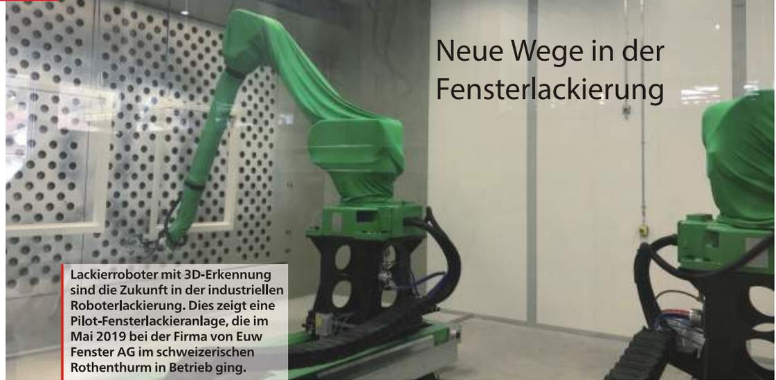
Lackierroboter mit 3D-Erkennung sind die Zukunft in der industriellen Roboterlackierung. Dies zeigt eine Pilot-Fensterlackieranlage, die im Mai 2019 bei der Firma von Euw Fenster AG im schweizerischen Rothenthurm in Betrieb ging.
