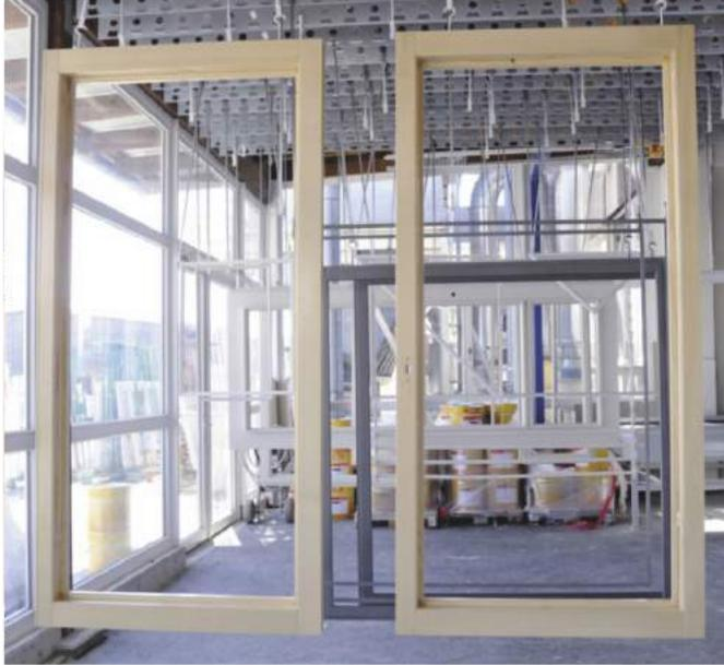
*! In rund drei bis vier Stunden trocknen Zwischenbeschichtung oder Deckschicht in der sehr großzügig bemessenen Trockenstraße mittels Umluft.*
