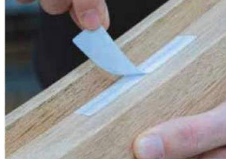
Das Etikett besteht aus zwei Schichten: nach dem Lackieren wird die obere Schicht einfach abgezogen
