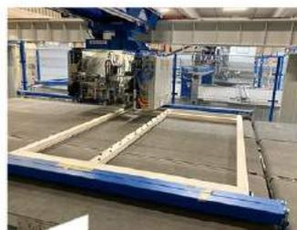
Vollautomatische Klipsmontage von Lemuth für die Aluschalen.
