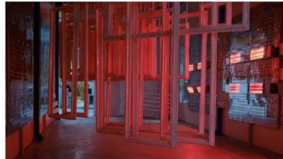
**Halogentrockner:** Der flotte Durchlauf ermöglicht eine kompakte Bauweise, da nur wenige Traversen gepuffert werden müssen
