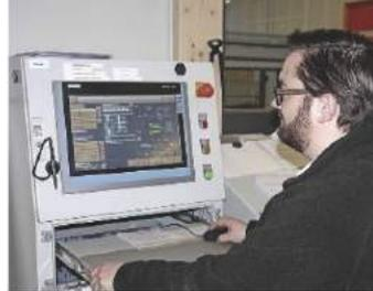
*Die Kontrollzentrale: Vom Leitreechner aus lässt sich auf jedes Werkstück zugreifen, das derzeit unterwegs ist.*
