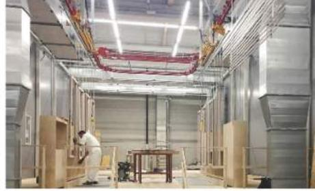
*/ Der großzügige Schleifbereich lässt die Wahl: Die Teile können entweder am Förderer hängend oder liegend geschliffen werden.*
