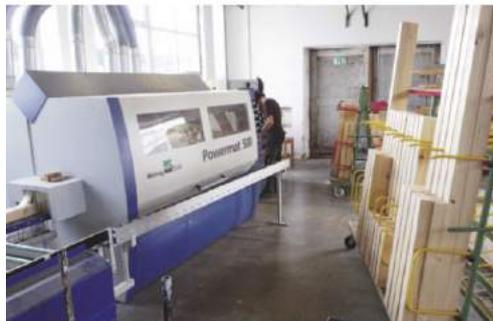
*! Fertigungstechnisch setzt der Augsburger Fensterhersteller auf Technologie von Weinig. Neben einem Powermat 500 ...*
