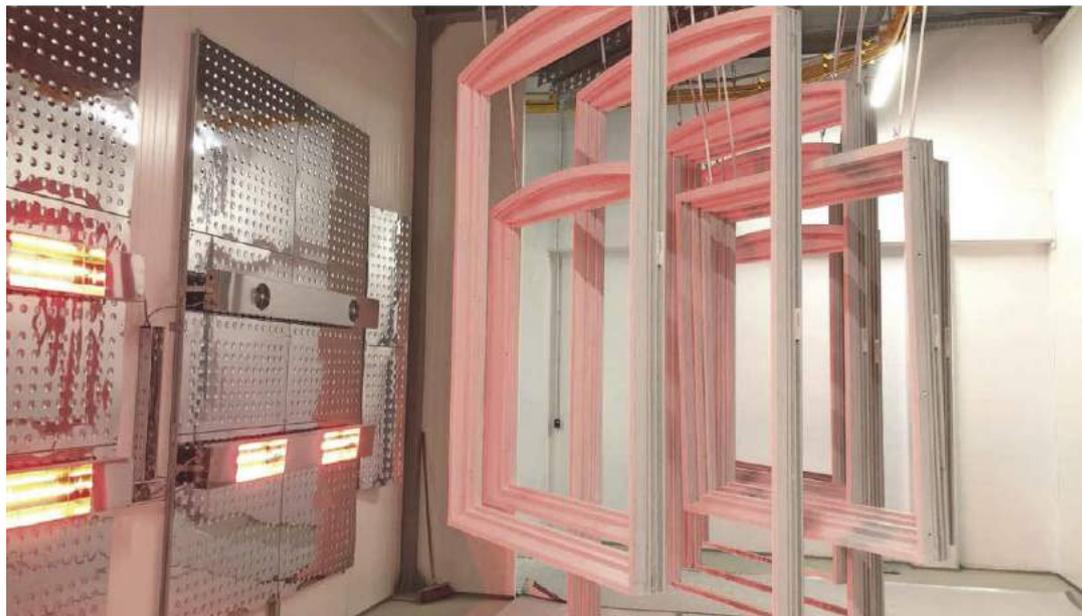
Halogentrocknung: Kurze Durchlaufzeiten dank Infrarotstrahlung
