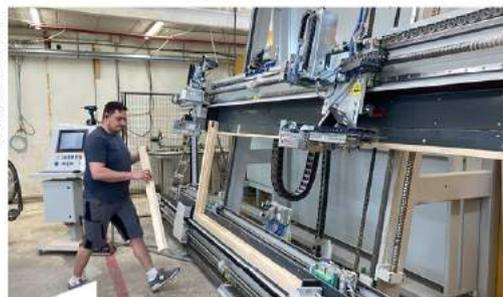
Die Rahmenpresse (S+S) verfährt automatisch. Die Positionierung der Presse erfolgt über Barcode.
