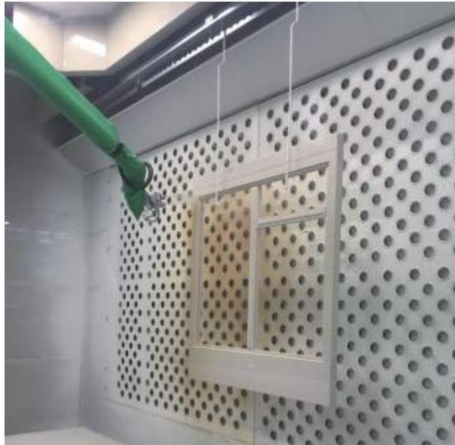
Die Abtropffläche ist mit Polypropylen verkleidet, das Material wird wieder in die Flutanlage zurückgeführt.
