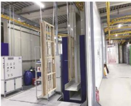
Neben der Flutanlage für lasierende Grundierungen steht eine weitere für deckende Aufbauten zur Verfügung
