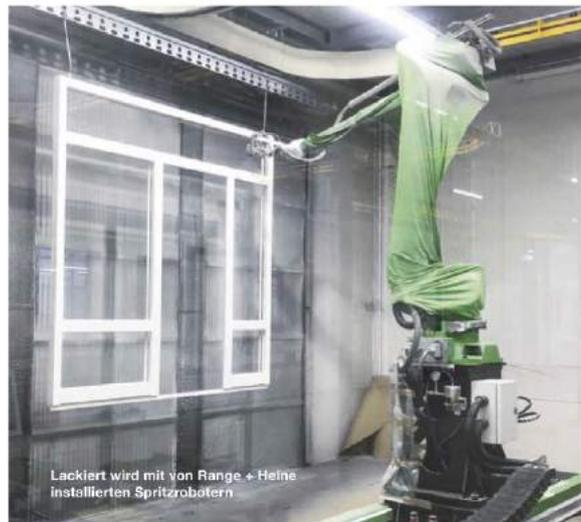
Lackiert wird mit von Range + Heine installierten Spritzrobotern
